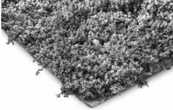
Über eine Vegetationsperiode im Freien vorkultivierte Pflanzenmatten für die schnelle Flächendeckung; speziell geeignet bei Schräg- und Tonnendächern oder windexponierten Dachflächen; mit fest verwurzelten Pflanzen (4-8 bewährte Sedum-Sorten sowie für extensive Dachbegrünung geeignete Kräuter und Gräser) auf einer verrottungsfähigen Trägereinlage; geringfügiger Schrumpf und Fremdbewuchs ist möglich. Liefergewicht: ca. 16-20 kg/m<sup>2</sup>, Dicke: 30-40 mm.
