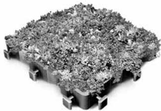
Mit Substrat verfülltes und mit verschiedene Sedum-Arten vorkultiviertes Gitterelement aus Recycling-LDPE zum Einsatz z. B. bei Schrägdachbegrünungen und zur Windsog-sicherung auf Flachdächern. Höhe inkl. Substrat ca. 35 mm. Abmessung der Basiseinheit: ca. 333 mm x 333 mm. Ausgestattet mit hoch belastbarer Steckverbindung.
